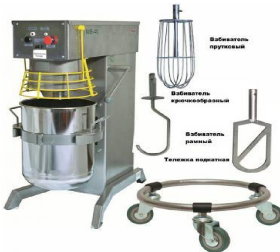
Рис.1- взбиватели. Прутковые взбиватели используют для взбивания легкоподвижных масс (сливки, яичный белок, муссы, самбуки и пр.). Плоскорешетчатые — для кондитерских смесей. Крючкообразный и замкнутый с перемычкой — для замешивания теста. Сменные взбиватели крепятся к рабочему валу с помощью легкоъемного соединения.
